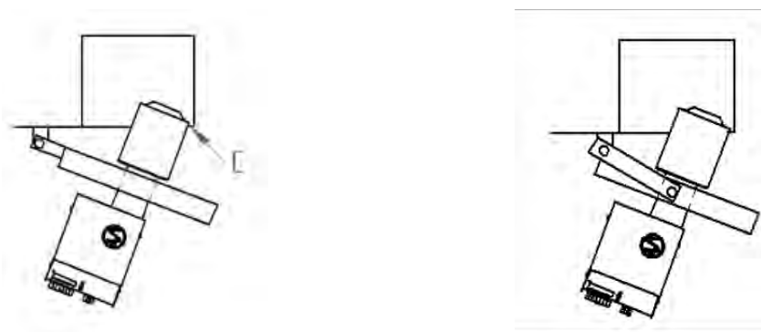
Рисунок 4 Положение петель и раствор дверцы котла
