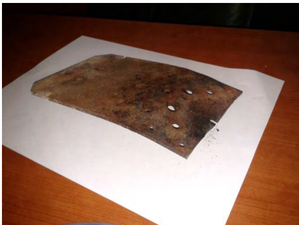
Фото 1 Деформированная решетка и прогоревшая камера сгорания
