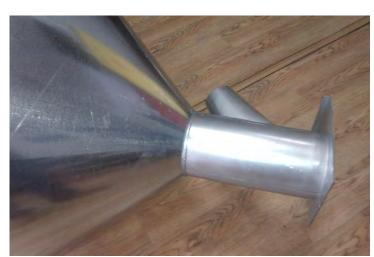
5. Зафиксировать соединение конуса и заборной горловины саморезами
